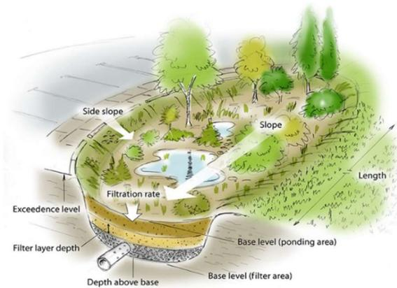
**Figure 5** : Schéma descriptif d'un jardin de pluie
