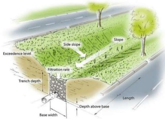
**Figure 4** : Schéma descriptif d'une noue
