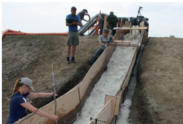
Vue d'un écoulement à 420 l/s/m sur un sol traité à la chaux (Salin de Giraud, mai 2018) (photo INRAE)
