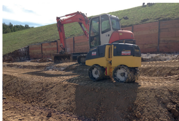
Petit compacteur vibrant à pieds dameurs (photo Lhoist)
