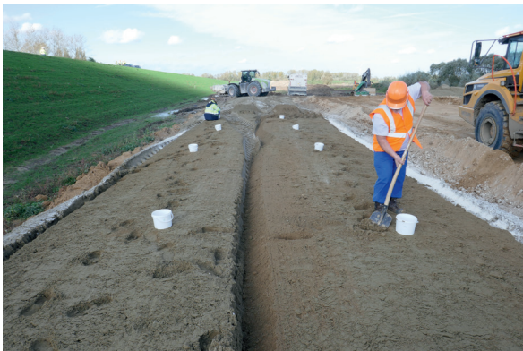
Réalisation de prélèvements pour mesure de la teneur en eau sur planche d'essais (photo Lhoist)
