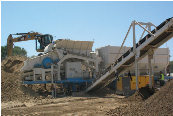
Centrale mobile de 100 t/h (photo DigueELITE)
