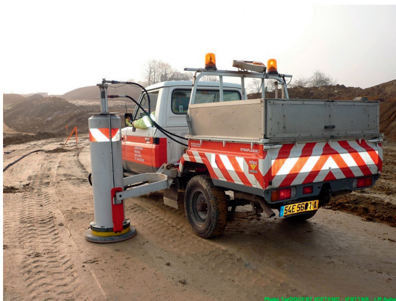
Figure 24 : Mesure de portance à la Dynaplaque II sur arase en sol A3 traité à 5 % CaO (chantier expérimental RD438 de Héricourt), (photo projet TerDOUEST)
