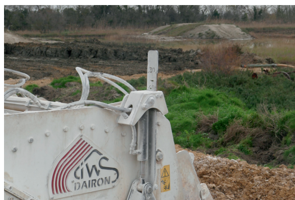
Contrôle de l'indicateur de la profondeur de malaxage installé sur la cloche du malaxeur (photo Lhoist)
