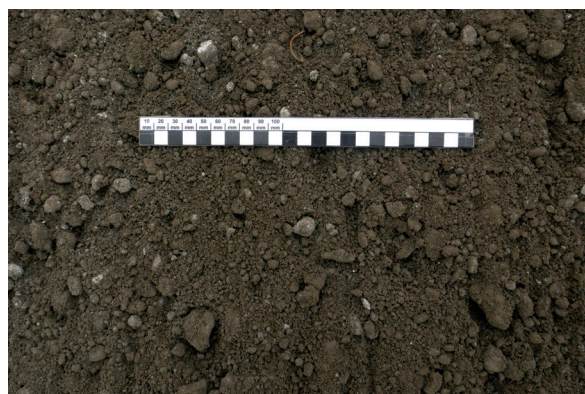
Détail de la mouture d'un sol A2 traité à 4 % CaO après 3 passes de malaxeur (photo Lhoist)
