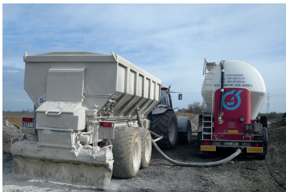
Contrôle visuel du chargement de l'épandeur sans émission de poussières (photo Lhoist)
