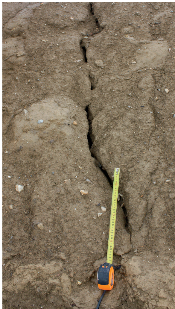
Fissures transversales sur le sol traité (à gauche) et sur le sol non traité (à droite) - Prise de vue 16/09/2016, construction + 422 jours (photos DigueELITE)
