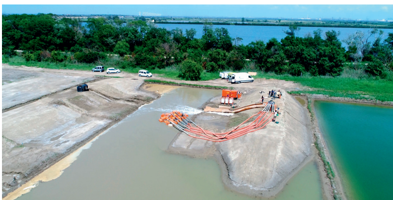
Figure 28 : Plots expérimentaux de Salin de Giraud - vue générale du site (plot en sol traité à gauche et plot en sol naturel en cours d'essais de surverse à droite) (photo SYMADREM)
