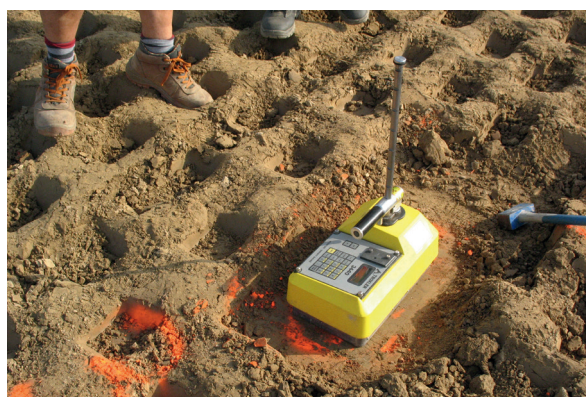
Figure 59 : Mesure de la masse volumique en place au moyen d'un gammadensimètre (photo DigueELITE)
