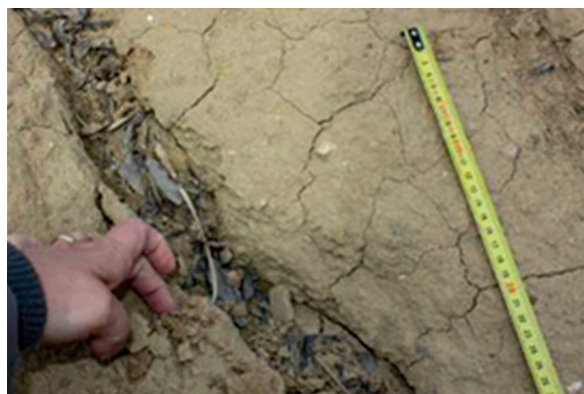
Altération du matériau aux abords des fissures sur le sol non traité - Prise de vue 24/02/2017, construction + 583 jours (photo DigueELITE)
