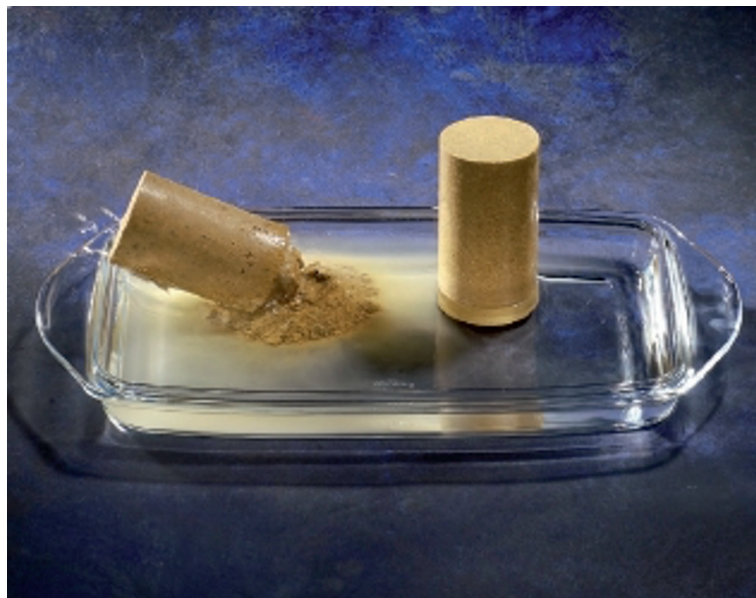
Figure 4 : Comportement d'éprouvettes après ¼ d'heure d'imbibition dans l'eau (sol A1 non traité à gauche et éprouvette du même sol traité à 2 % de chaux à droite) ; éprouvettes confectionnées 24 heures avant la mise en imbibition
