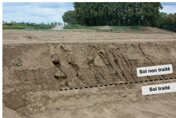
Ravine d'érosion sur le sol non traité à gauche et contraste de comportement entre le sol traité (talus lisse) et le sol non traité (talus avec ravines) à droite (construction + 3 mois) (photos DigueELITE)
