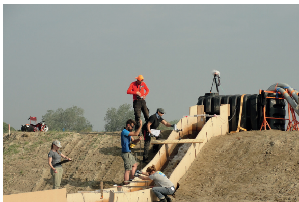
Vue générale d'un essai de surverse (Salin de Giraud, mai 2018) (photo Lhoist)
