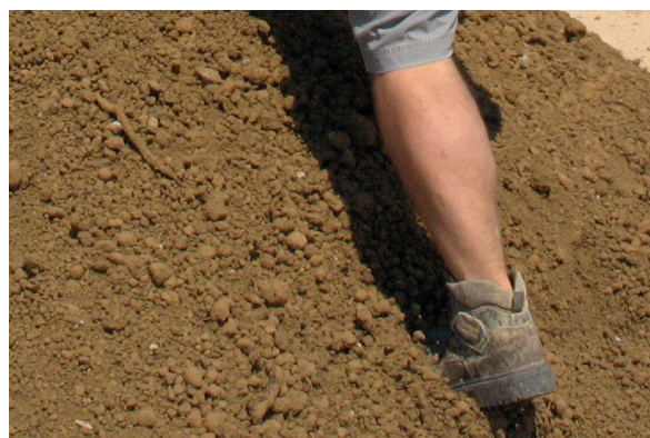
Détail de la mouture d'un sol A1 traité à 2 % CaO en sortie de centrale (chantier expérimental du Vidourle Projet DigueELITE)
