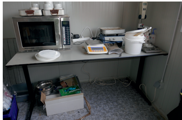
Laboratoire de chantier pour mesure de la teneur en eau avec four à micro-ondes (photo Lhoist)
