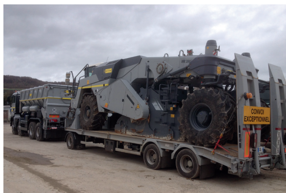
Figure 38 : Vue d'un atelier de traitement comprenant un épandeur et un malaxeur automoteurs en mode de transfert au gabarit routier (photo Entreprise Lhotellier)
