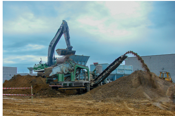
Centrale mobile de traitement 200 t/h (photo Lhoist)
