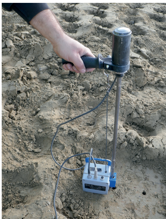
Figure 60 : Mesure de la résistance de pointe en fonction de la profondeur au moyen d'un pénétromètre léger (photo DigueELITE)
