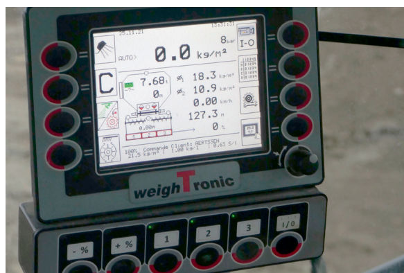
Affichage du système de pesage embarqué d'un épandeur- affichage du poids de chaux restant dans l'épandeur (photo Lhoist)
