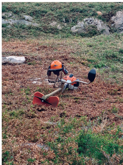
Figure 13. Débroussaillieuse utilisée par les APFM lors de traitements manuels du combustible © Arthur Boschet/INRAE
