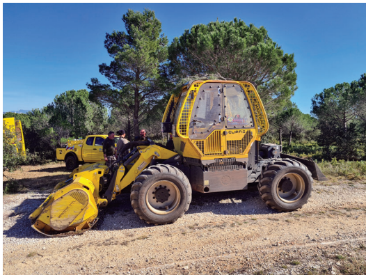
Figure 14. Tracteur équipé d'un gyrobroyeur à marteaux utilisé par les APFM lors de broyage mécanique © Arthur Boschet/INRAE
