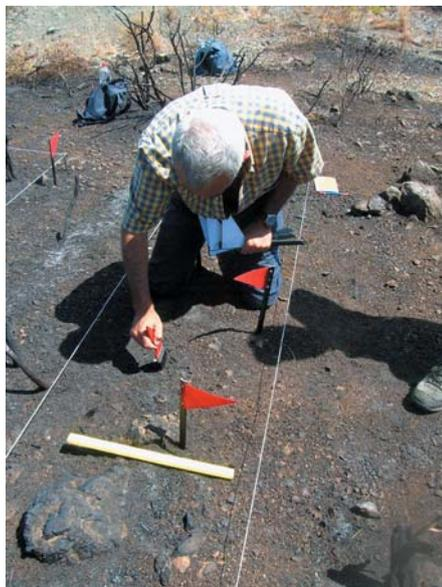
Les détails observés in situ sur les vestiges laissés par le passage du feu sont ensuite analysés à partir de la méthode dite « méthode des preuves physiques » : les traces laissées sur la végétation (trunks, branches, houppiers, herbes, etc.) ou sur des éléments physiques (pierres, poteaux,
