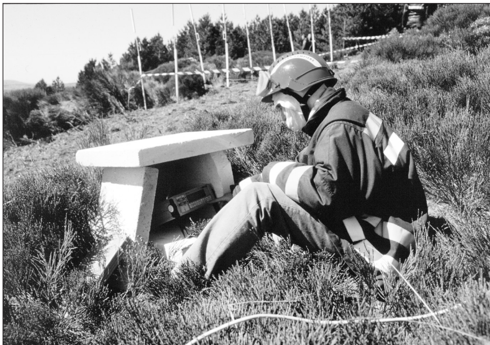
Des mesures de température du sol ont aussi été prises avant et pendant l'incendie. Elles permettent d'évaluer les modifications induites par le passage du feu.
