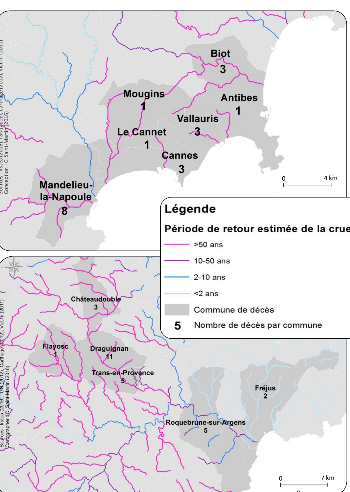
Figure 3 : périodes de retour maximales estimées pour les débits modélisés AIGA lors des événements du 03/10/2015 (en haut) et du 15/06/2010 (en bas) et localisation des victimes.
